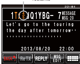
Pantalla de lista de mensajes (cuando el número de transmisiones pendientes es de cuatro)
